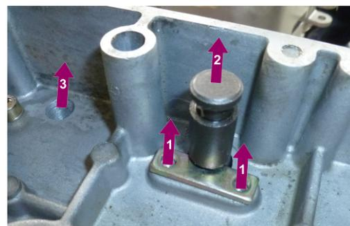
4. Соблюдая соосность осей и отверстий соединительной планки, а также учитывая взаимное расположение тележки и тали (двигатели должны находится с одной стороны), установите соединительную планку на таль. Произведите сборку в обратном порядке.
