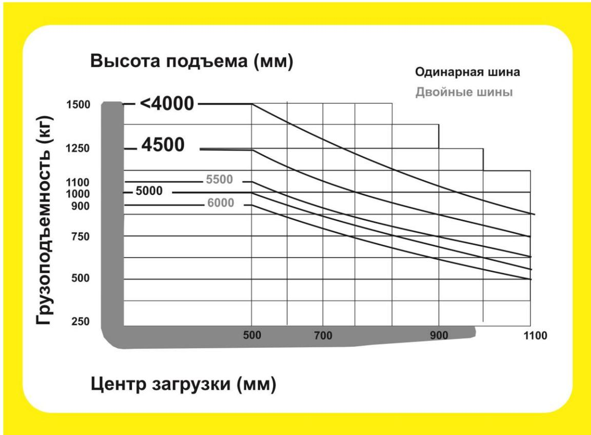
У погрузчика с мачтой высотой 4500 мм фактическая грузоподъемность будет меньше 1250 кг его номинальной грузоподъемности, если центр загрузки удален от спинок вилок на 700 мм. Чтобы определить по графику фактическую грузоподъемность при расстоянии до центра загрузки в 700 мм, следует от места пересечения вертикали, идущей от отметки 700 мм на шкале расстояния до центра загрузки, с кривой, соответствующей высоте подъема на 4500 мм, провести горизонталь к шкале грузоподъемности.
